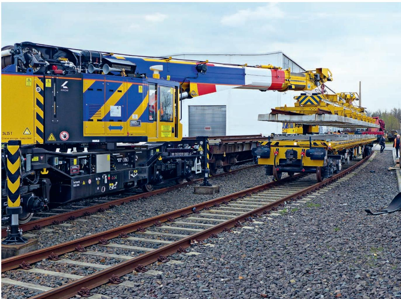
Für spezielle Anforderungen können die Switch Tilter und die Zusatzausrüstung für das Weichenhandling angepasst werden.
