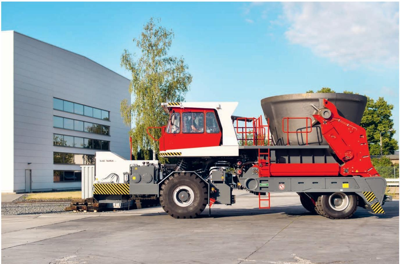
SLAG TAURUS P mit Schlackekübel in Fahrposition
