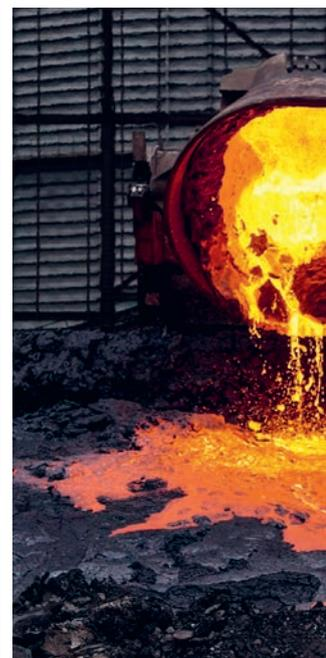
Kompletter Kippablauf mit Flüssigschlacke am Schlackenbeet
