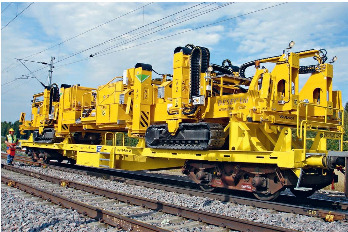
Der Tracklayer kann auf der Schiene oder auf der Straße transportiert werden. Er kann sich selbstständig, ohne externe Hebezeuge, auf einen Eisenbahnwaggon oder auf einen LKW-Trailer aufladen und sich auch wieder selbst abladen.
