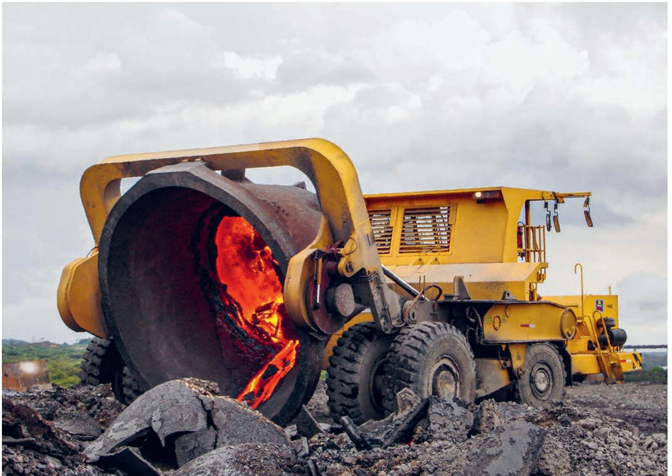
SLAG TAURUS U 120 mit gekipptem Schlackekübel an der Klopfstation
