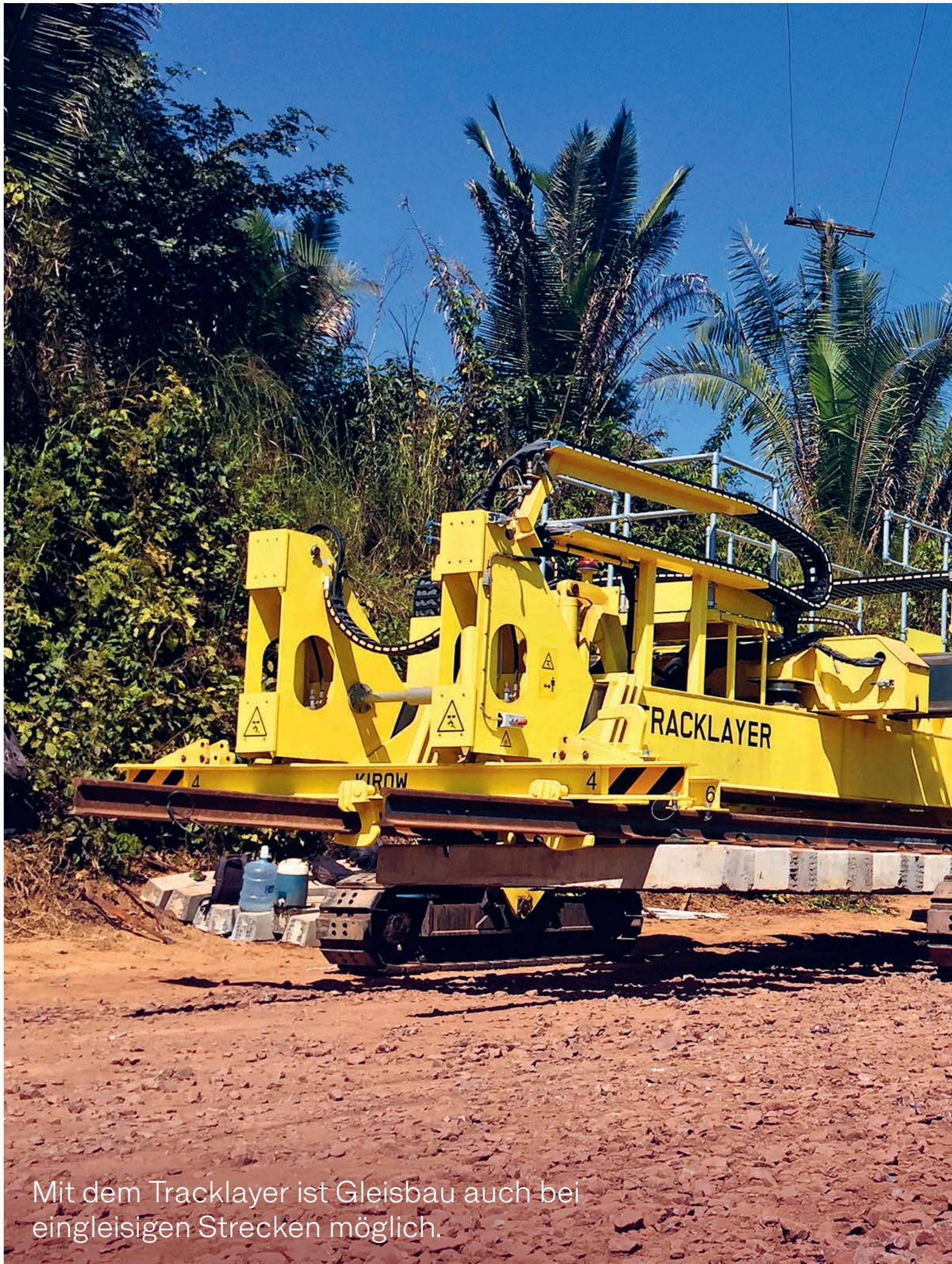
Mit dem Tracklayer ist Gleisbau auch bei eingleisigen Strecken möglich.
