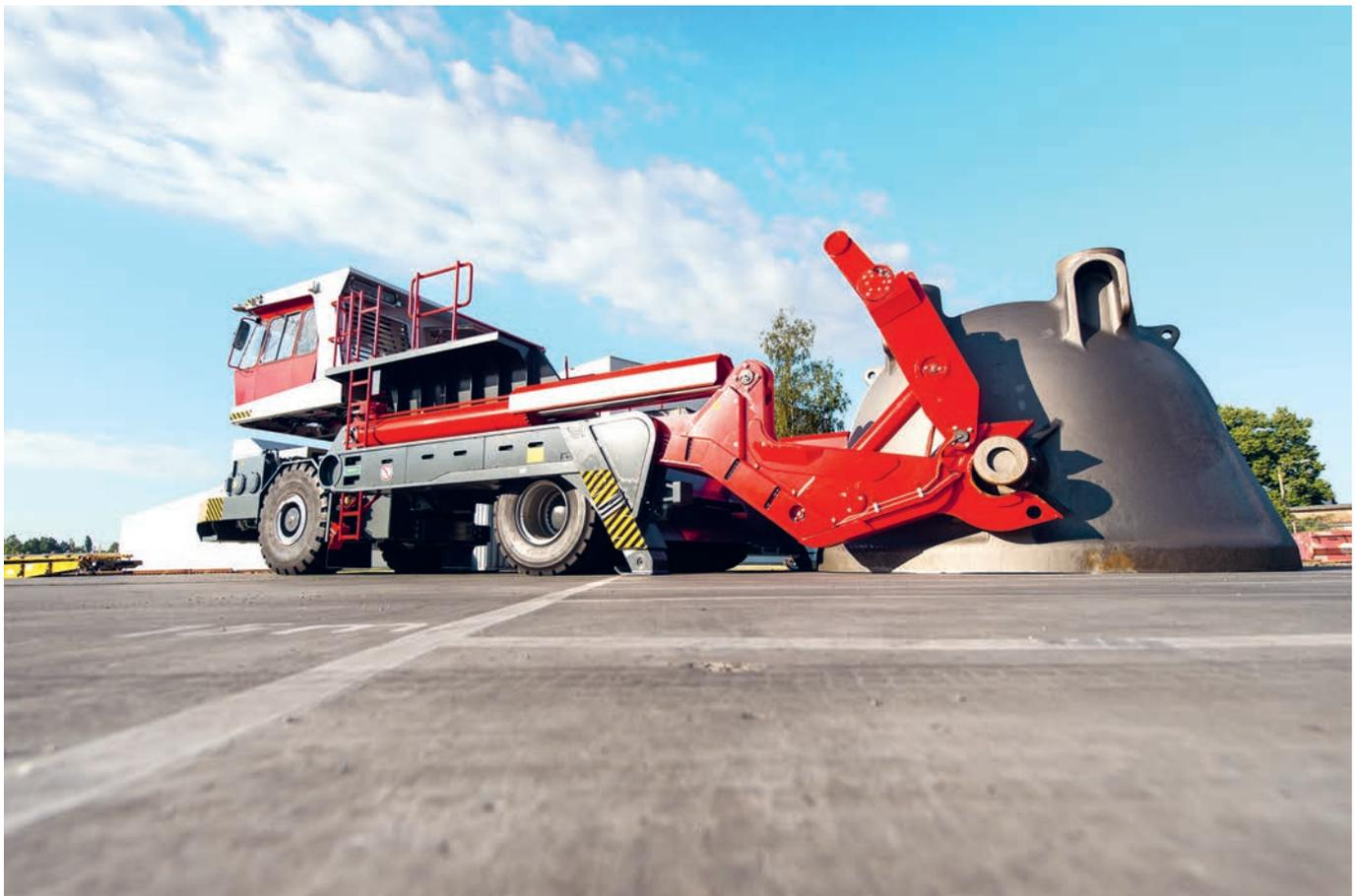
SLAG TAURUS P mit Schlackekübel bei Überkopfablage
