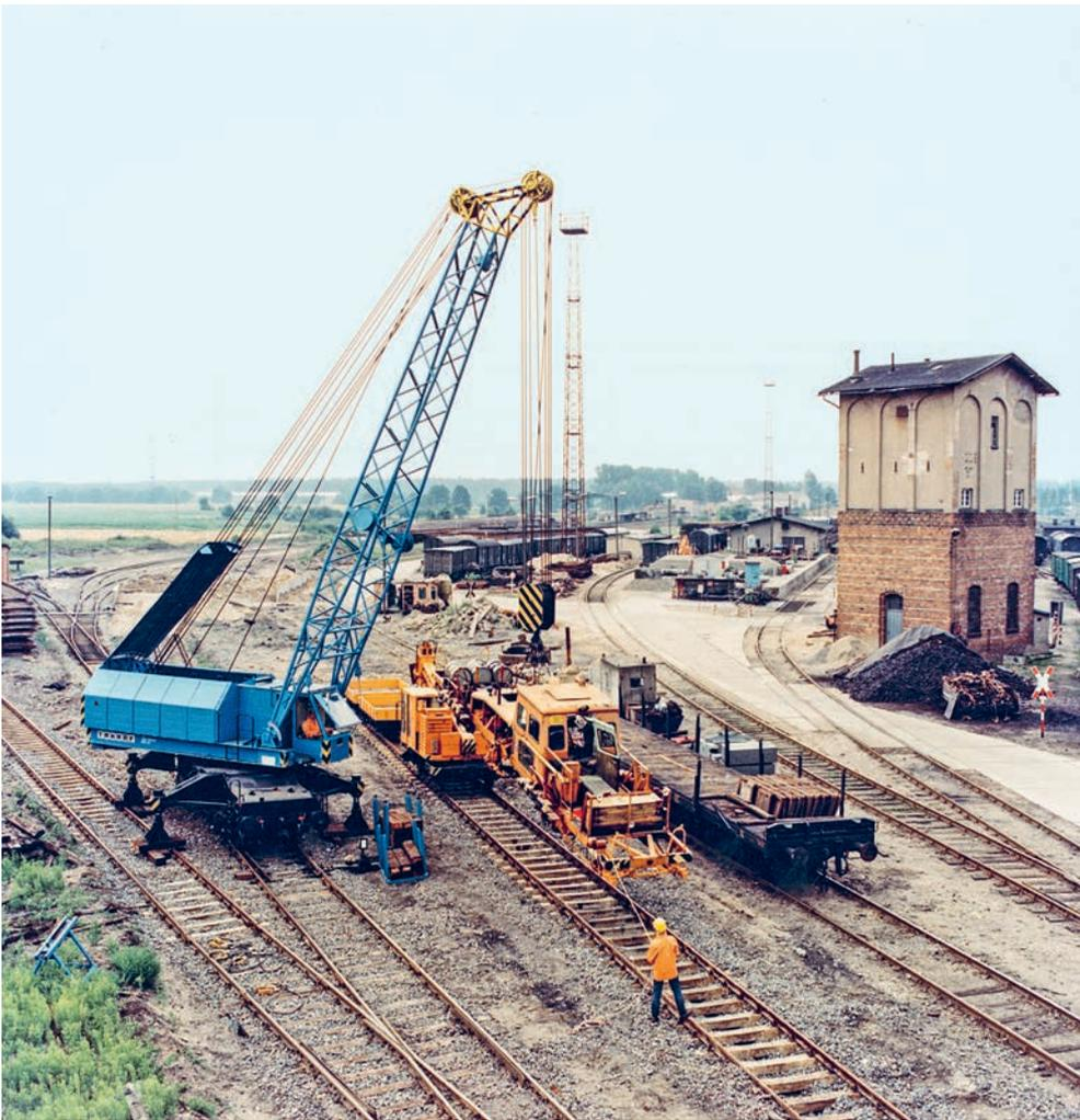
Die neue Generation der Kirow Eisenbahndrehkrane zeichnete sich durch leichte, elegante Ausleger und einen dieiselektrischen Antrieb aus und war, da in hoher Stückzahl produziert, im Anschaffungspreis günstig. Hier ein EDK 300 bei der Montage eines Eisenbahnfahrzeuges.
