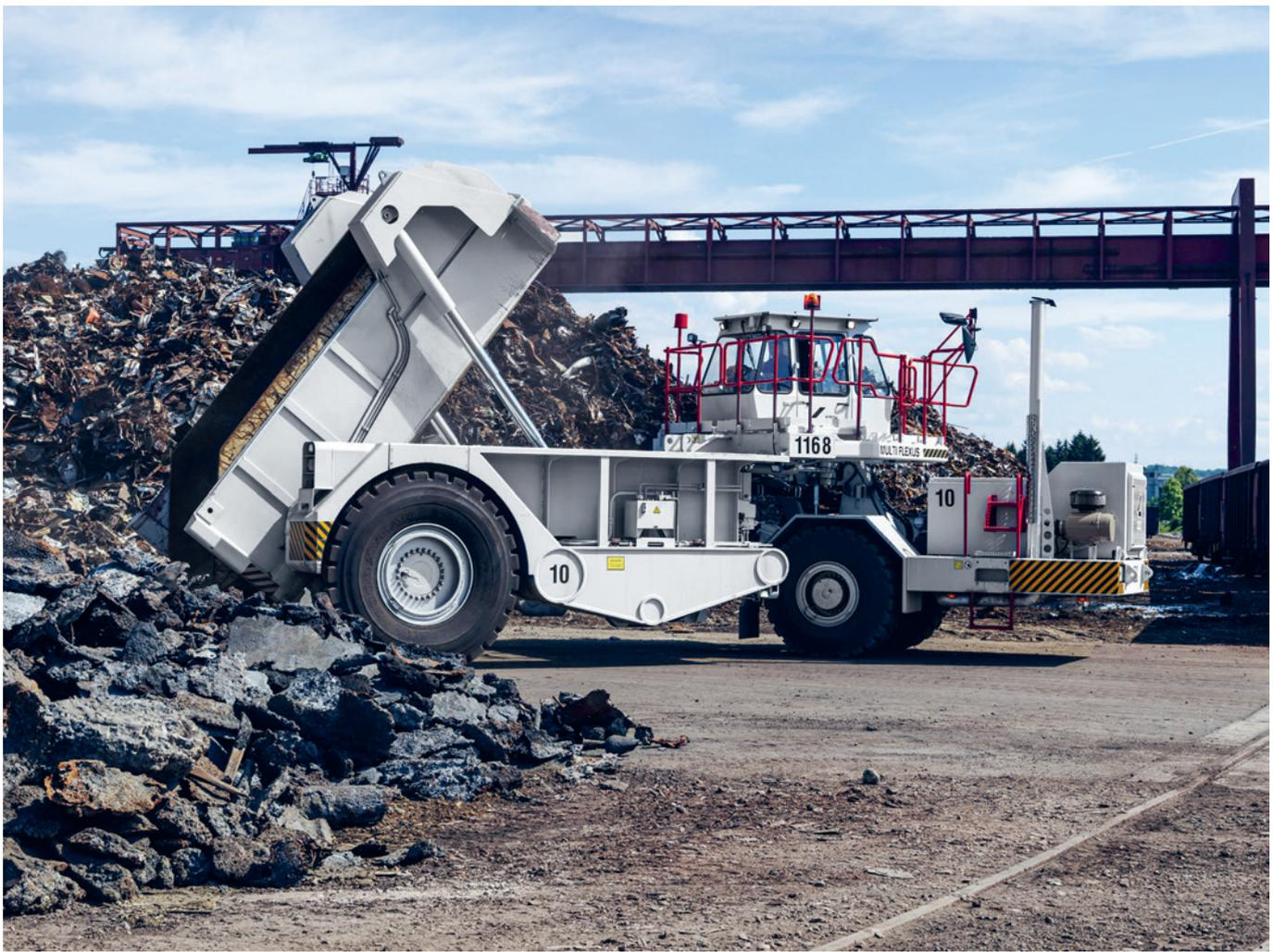
Der Multi Flexus D transportiert eine unübertroffene Bandbreite kleinerer Nutzlasten. Transportiert werden können Schrott in Schurren und Mulden sowie Schlämme, Coils, Brammendstücke, Filterstäube, Müllcontainern und vieles mehr. Die Mulden oder Flachpaletten werden dabei direkt vom Boden aufgenommen und sind in der Herstellung äußerst günstig und immens variabel. Selbstverständlich verfügt der Multi Flexus D auch über eine Kippvorrichtung.
