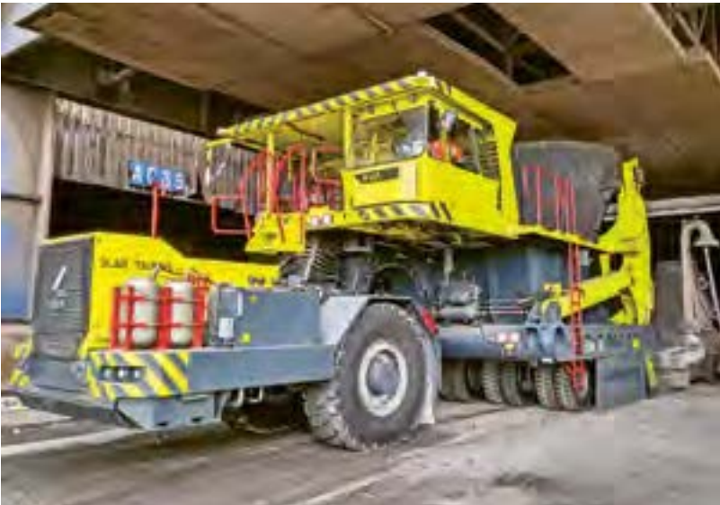
Der Slag Taurus P 95 bei der Aufnahme eines Schlackenkübels vom Übergabewagen / Slag Taurus P 95 picking up a slag pot from the transfer car
