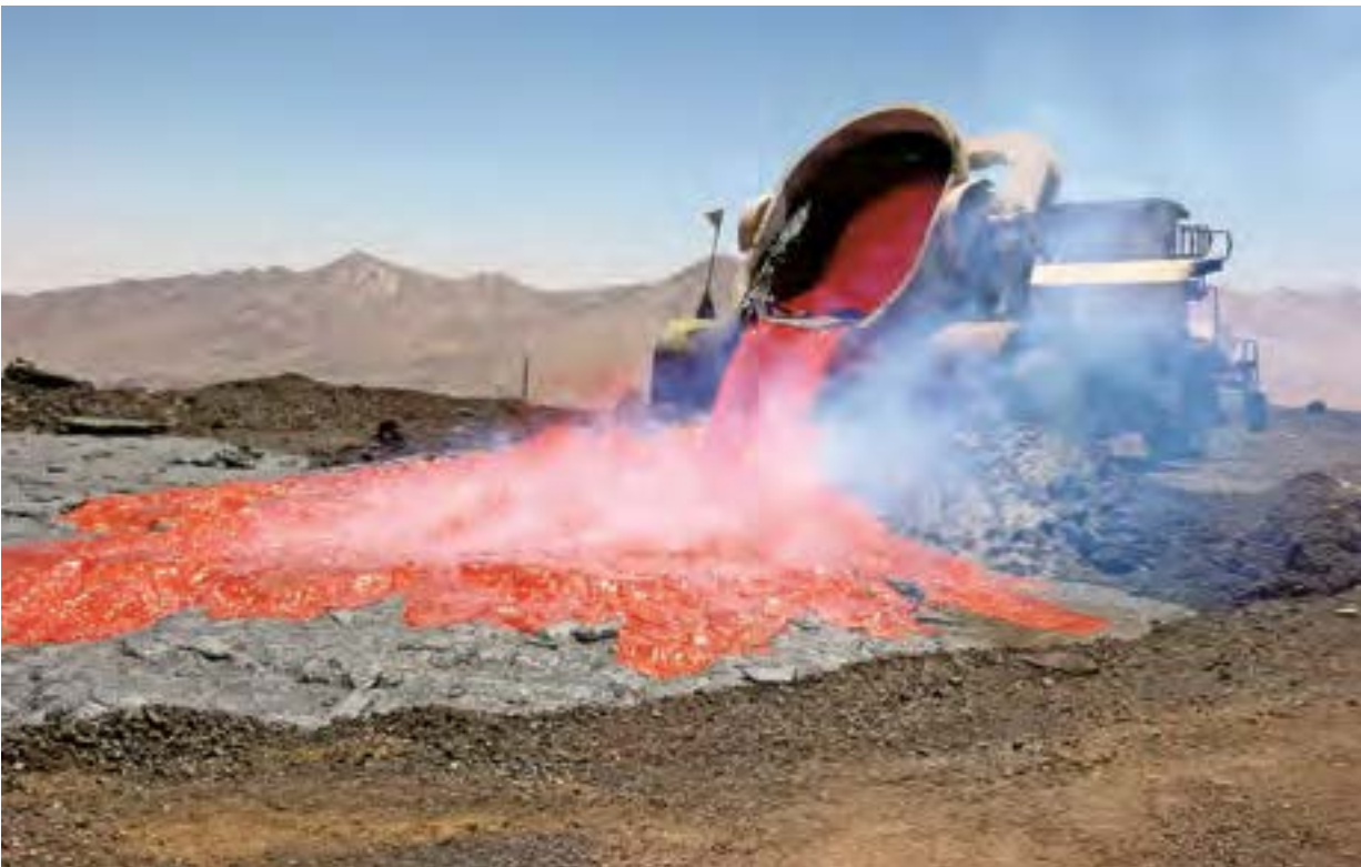
Der Slag Taurus U 100 beim Kippen von Kupferschlacke für den Kunden Codelco, Chile, 2004 / Slag Taurus U 100 dumping copper slag at the facility of our customer Codelco, Chile, 2004
