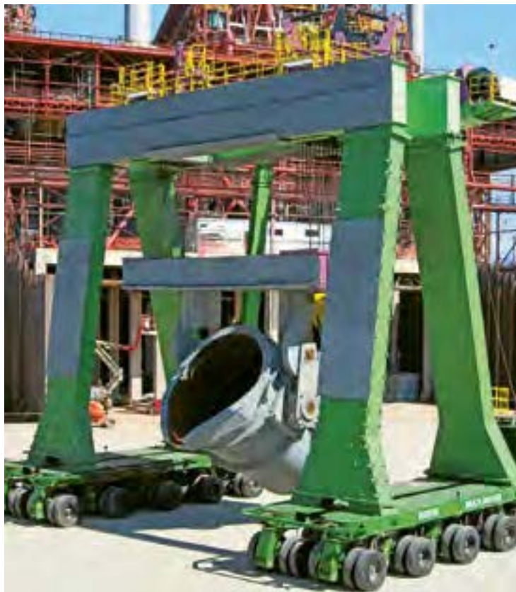
Der Multi Mover Y 550 mit Roheisenpfanne / Multi Mover Y 550 with pig iron pot ladle
