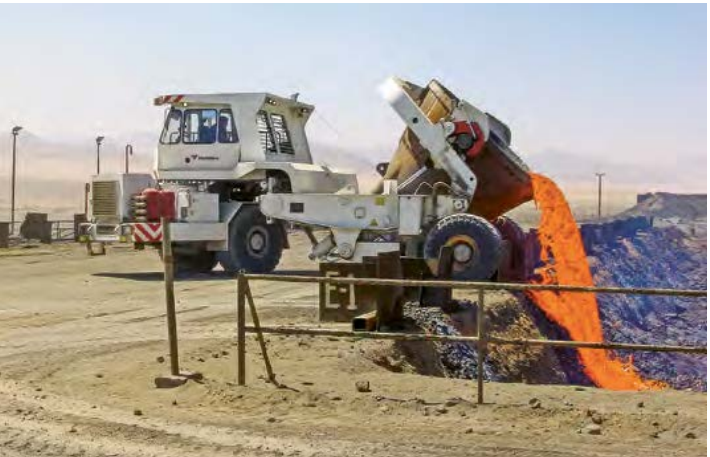
Der Slag Taurus in U-Rahmenbauweise / Slag Taurus with U-frame design
