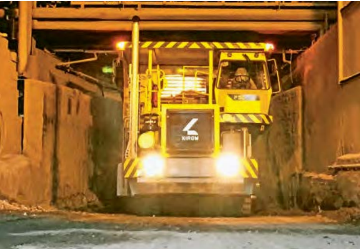
Der Slag Taurus P 50 bei der Kübelaufnahme unter engen Platzverhältnissen / Loading the pots of Slag Taurus P 50 in confined spaces
