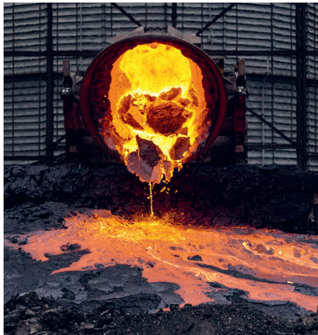
Kompletter Kippablauf mit Flüssigschlacke am Schlackenbeet Liquid slag handling process at the slag yard
