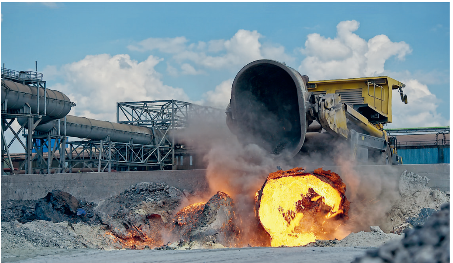
Abwerfen eines Schlackebären mit Metallanteil Tipping of a scull with high metal content
