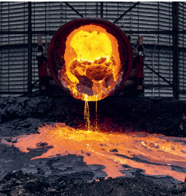
Kompletter Kippablauf mit Flüssigschlacke am Schlackenbeet Liquid slag handling process at the slag yard
