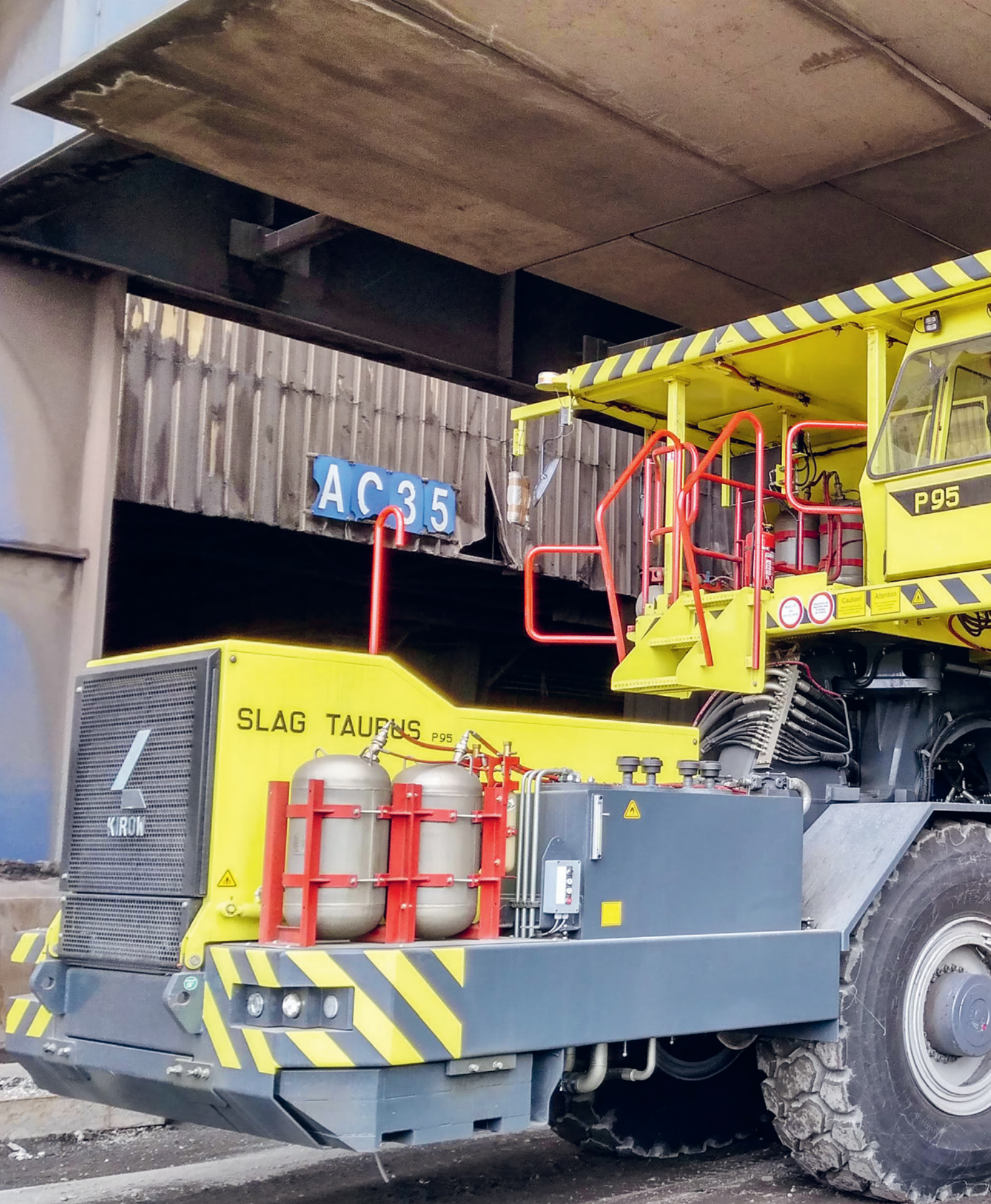
Aufnahme des Schlackenkübels von einem Übergabewagen im Ofenbereich
