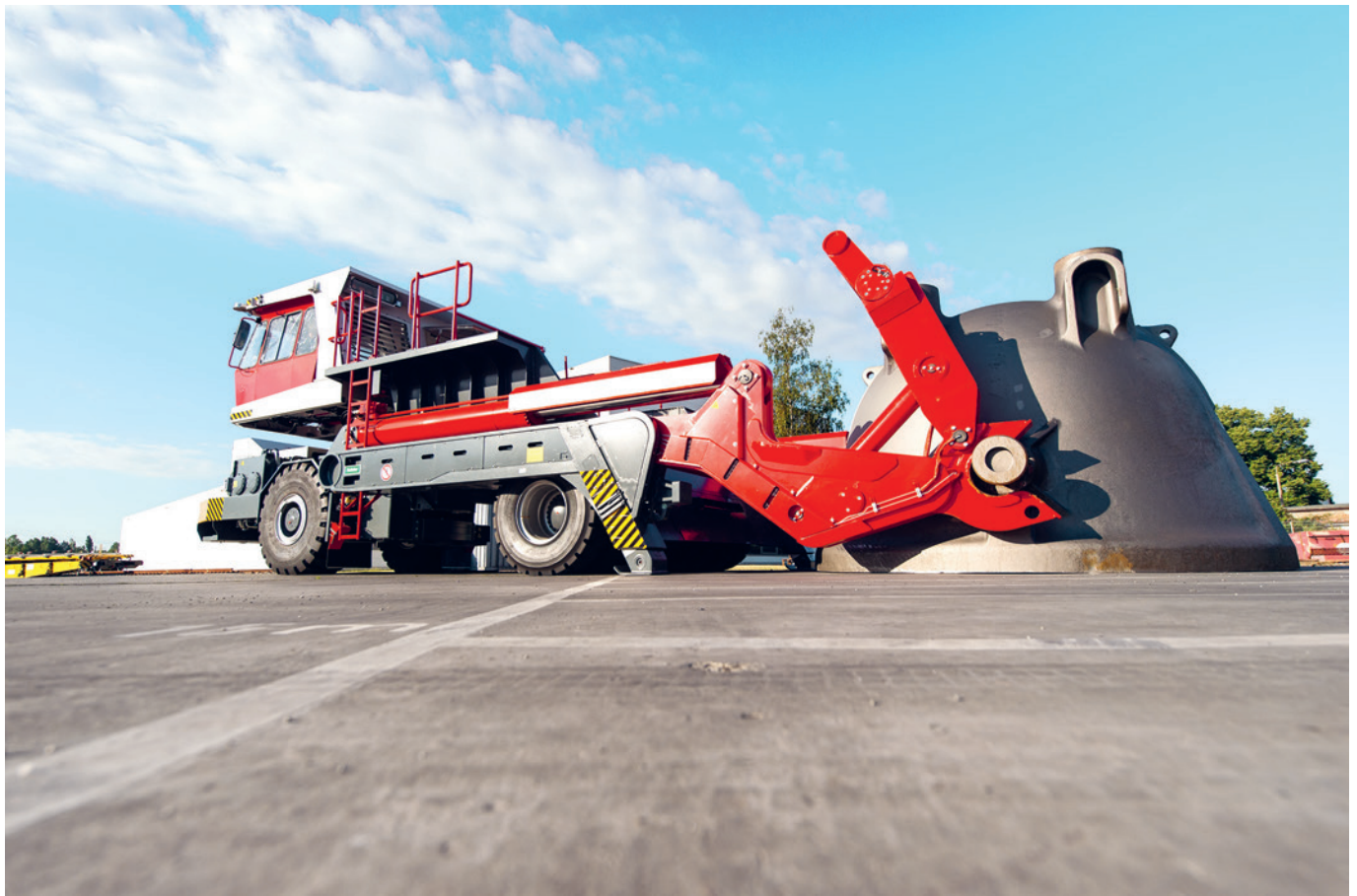
TECHNE SLAG TAURUS P mit Schlackekübel bei Überkopfablage TECHNE SLAG TAURUS P with slag pot in upside-down position
