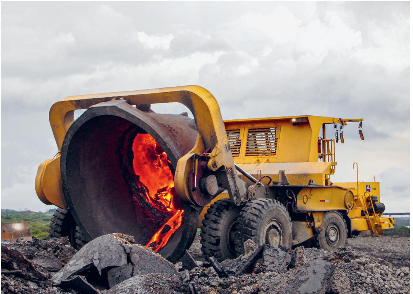
SLAG TAURUS U 120 mit gekipptem Schlackekübel an der Klopfstation SLAG TAURUS U 120 with tilted slag pot at the knocking station
