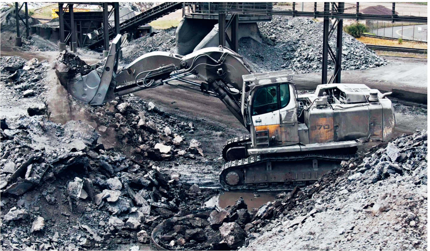
Trennen der Metallanteile aus der kalten Schlacke Separation of residual metal from cold slag
