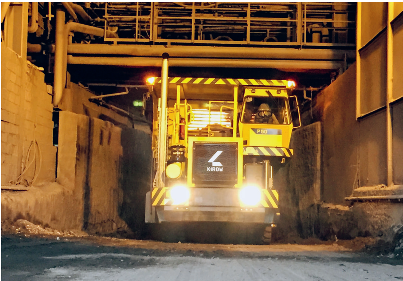
SLAG TAURUS P 50 bei der Kübelaufnahme unter engen Platzverhältnissen SLAG TAURUS P 50 picking up slag pots under narrow conditions
