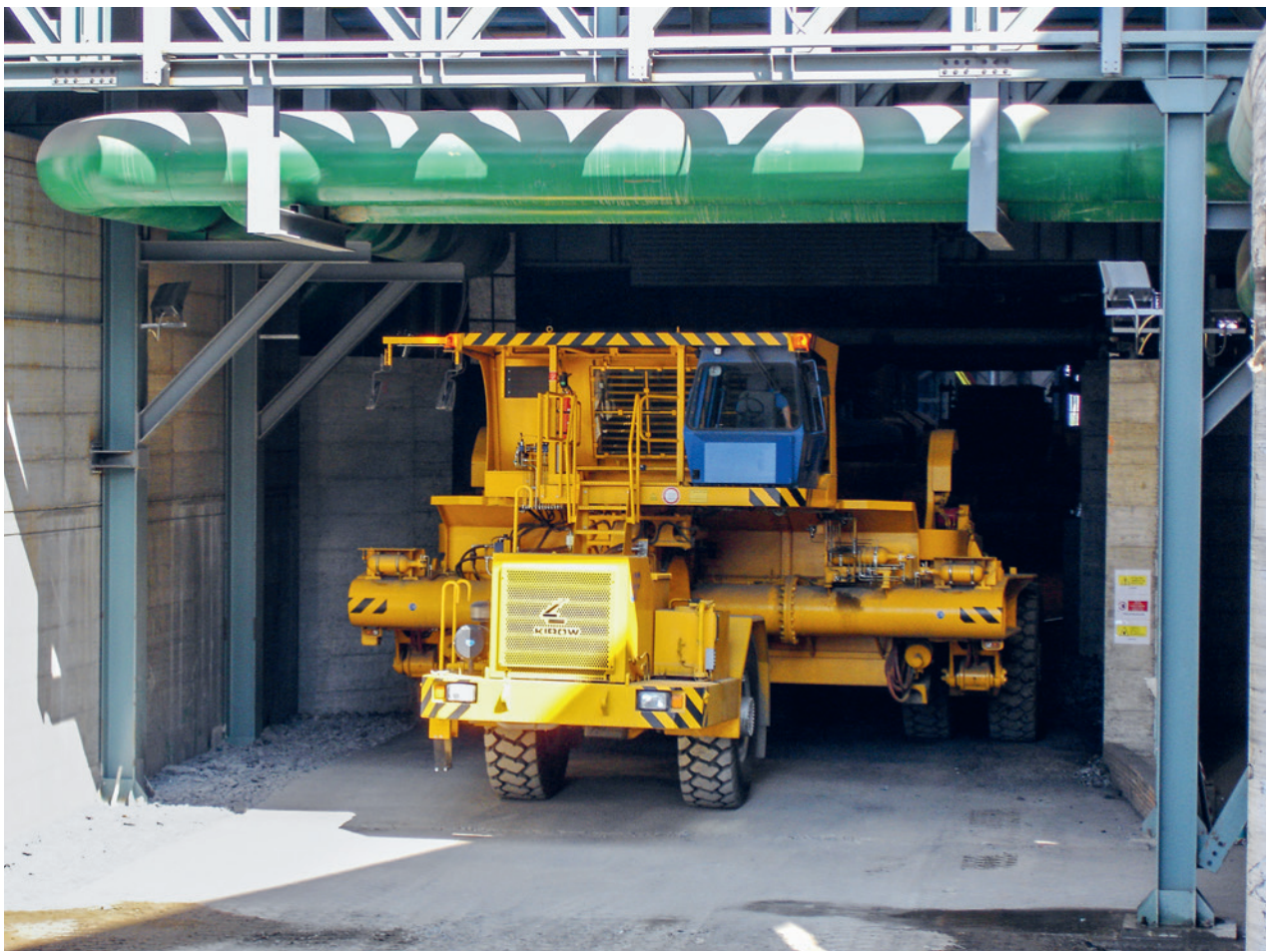
SLAG TAURUS U 120 bei der Kübelaufnahme unter niedrigen Platzverhältnissen SLAG TAURUS U 120 picking up slag pots under low-height conditions
